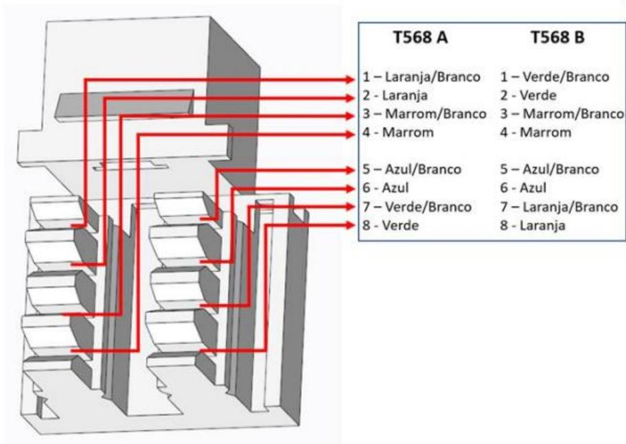
3. Após colocar a sequência correta dos fios, corte o excesso para poder encaixar os suportes de acordo com a figura abaixo, pressione até sentir o encaixe.
